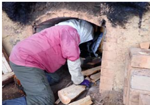
炭っこ倶楽部。炭材を窯の中に隙間無く詰め込むのが難しい。
