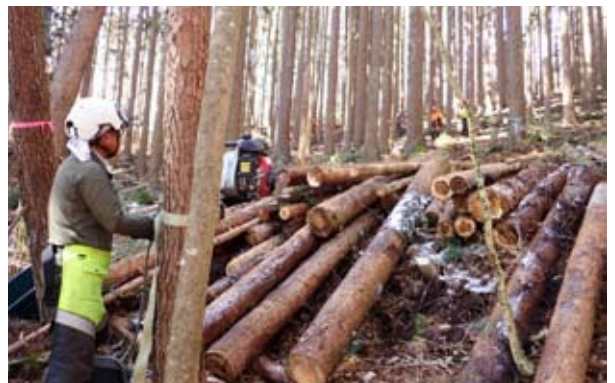
1月の間伐倶楽部にて、ポータブルウィンチを使って集材。
